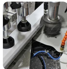
**Фрезеровка обратными фрезами**
