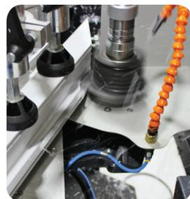
**Фрезеровка прямыми фрезами**
